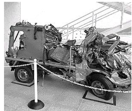
津波で変形した消防車
